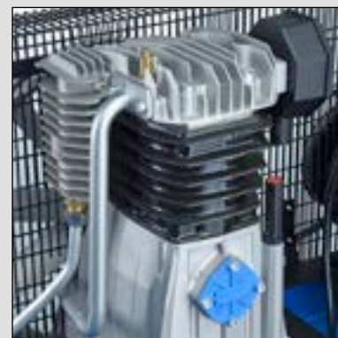
Dvoustupňový kompresor s tlakem 11 bar s dochlazovačem
