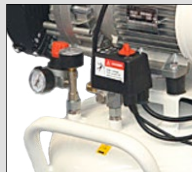
Kvalitní tlakový spínač a regulátor tlaku
