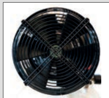
Přidaný ventilátor pro účinné chlazení kompresorové jednotky
