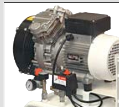
Silný bezolejový kompresor se 2 písty
